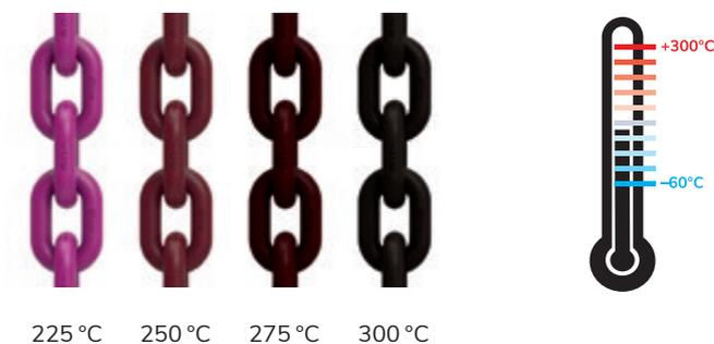
Le revêtement par poudrage rose fluorescent de la chaîne VIP change également de couleur de manière permanente en cas de températures de fonctionnement extrêmes, dans ce cas à plus de 200 °C. Si la chaîne est chauffée de manière intolérable à plus de 380 °C, la couleur vire au noir profond et de petites cloques se forment. La chaîne VIP doit alors être remplacée.
