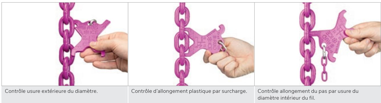
Contrôle usure extérieure du diamètre.
