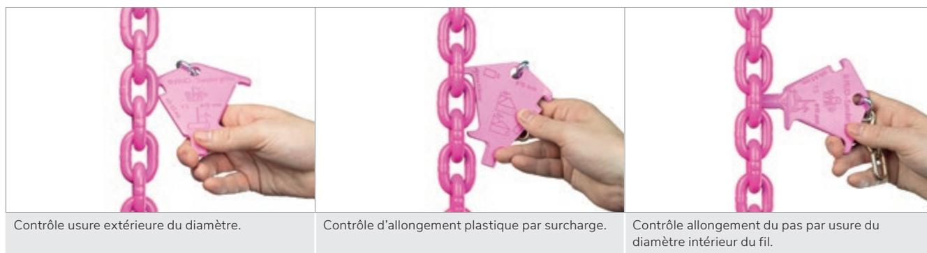
Contrôle usure extérieure du diamètre.
